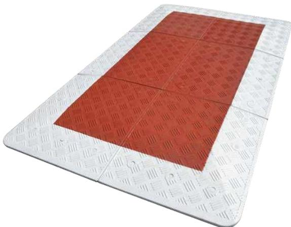
Es besteht aus sehr UV-beständigem vulkanisiertem Gummi. Die einzelnen Segmente sind durch Metallverbindungsstücke miteinander verbunden. Die rote Mittelfläche ist von einer seitlich abgeschrägten weißen Fläche umgeben, wodurch das Fahrbahnkissen noch sichtbar ist.
